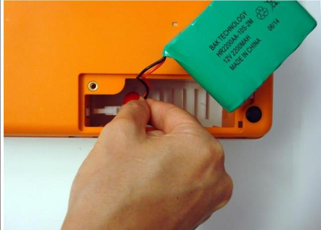
2. Desconecte el conector de la batería.
