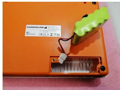
4. Deje el aparato con la batería desconectada durante 60 minutos (tiempo necesario para restablecer la memoria de calibración de la pantalla táctil).
